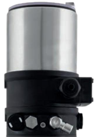
Die digitalen Stellungsregler gehören zur Standardausstattung der KIESELMANN Regelventile mit Hubkolben- und Membranantrieb. Sie zeichnen sich durch eine hohe Regelgenauigkeit aus. Die Stellungsregler arbeiten im Signalbereich von 4 bis 20 mA. Sie regeln aber auch im Teilbereich beziehungsweise Split-Rangebetrieb.
