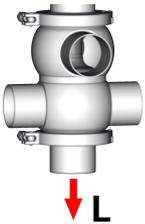
Das Ventil öffnet von oben nach unten mit Steuerluft und schließt von unten nach oben mit Federkraft produktverlustfrei. In der Zustellung wird der obere und untere Ventilgehäuseraum, bei durchfließenden unterschiedlichen Medien, durch zwei unabhängig geschlossene Ventilteller leckagesicher getrennt. Auftretende Leckagen, bedingt durch beschädigte Ventiltellerdichtungen, werden drucklos über den Leckageablauf (L) ins Freie abgeführt.
