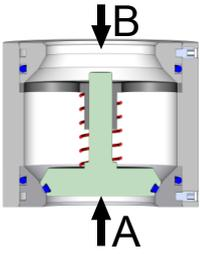
Клапан открывается под действием потока жидкости или газа в направлении «А», против направления действия пружины при превышении потоком определенного давления (см. Таблицу 5.1.1 [► 10]), и Клапан закрывается в направлении «В» под действием пружины, при снижении рабочего давления потока менее 0.1 бар.
