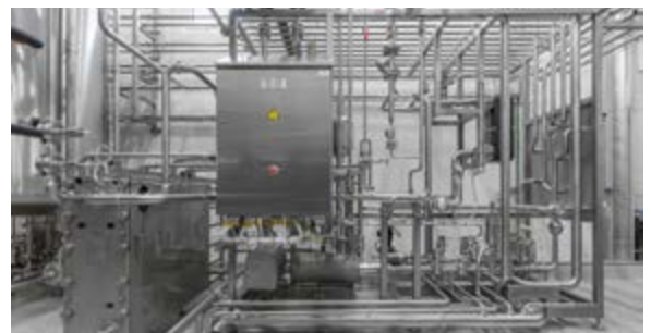
KZE-Anlage: Sicherstellung der Qualität und Haltbarkeit vor dem Abfüllen sowie zur Unterbrechung der Gärung, um alkoholfreie Getränke herzustellen.
